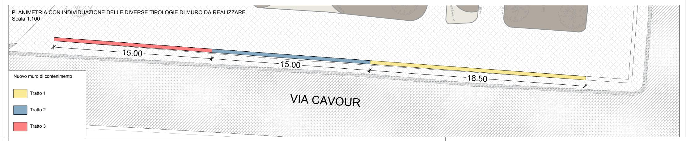
Il nuovo muro di contenimento sarà realizzato in c.a. e sarà rivestito in pietra locale. E' possibile distinguere tre tratti diversi, riepilogati di seguito:
